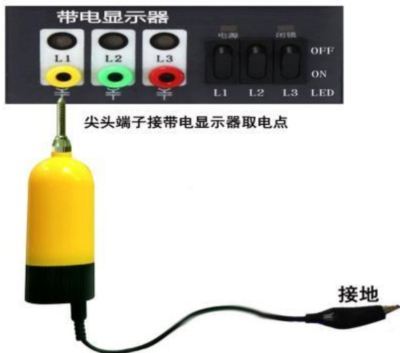
带电显示器核相示意图 (图 3)
